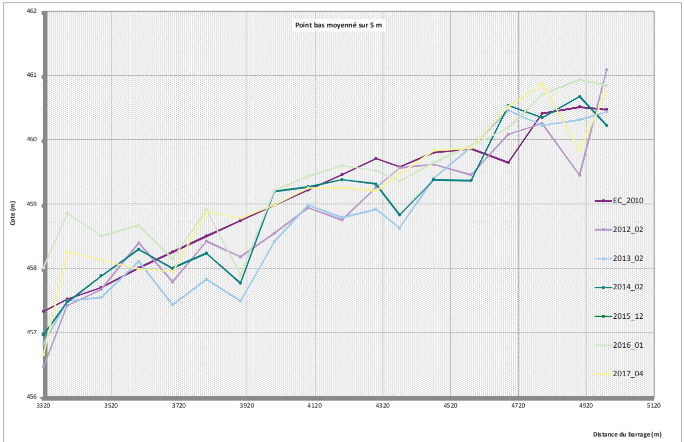
Figure 10. Profils en long des points bas de la branche Durance
